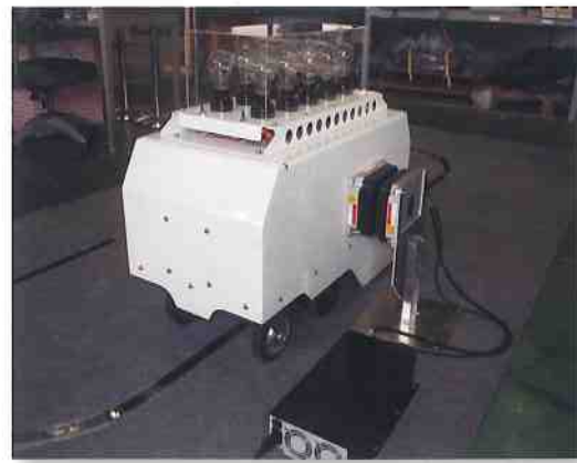
非接触による給電の様子
